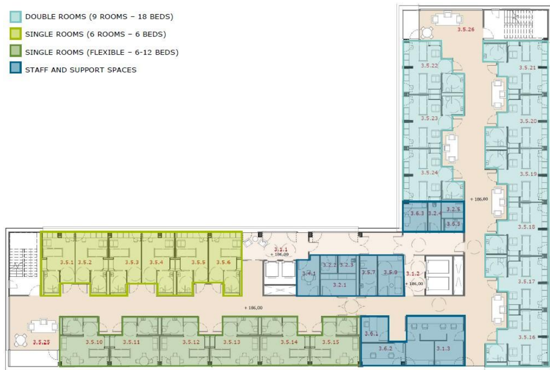
Fig. 26: Planta flexible de internación, con 6 habitaciones configurables (a simples o dobles) Centro de Atención Intermedia e Integrada, Barcelona. Albert Vitaller, arq.
